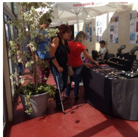
Figura 46 – Ocupação de vias de evacuação com atividades pontuais, não assegurando condições mínimas de segurança
