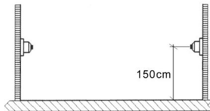
Os detetores de CO devem ser instalados a uma altura de 1,5 m do pavimento e distribuídos uniformemente de modo a cobrir áreas inferiores a 400 m<sup>2</sup> por cada detetor.
