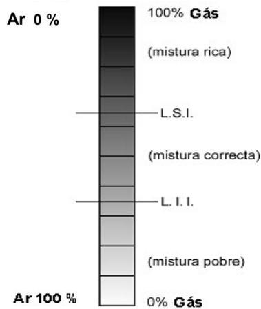
c) Para que se dê início a uma combustão, para além da mistura correta de ar e gás, necessita-se de uma fonte de energia exterior, que permita atingir a **temperatura de ignição**:
