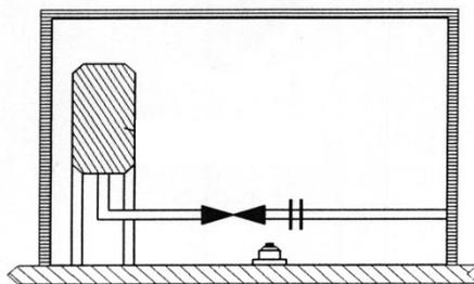
Qualquer sensor de gás ou vapor combustível, explosivo ou tóxico não deve ser colocado por áreas de cobertura, mas em função dos locais onde possam ocorrer fugas ou explosões, tais como salas de contadores e válvulas, queimadores, pontos de derivação, ductos de passagem, etc.
